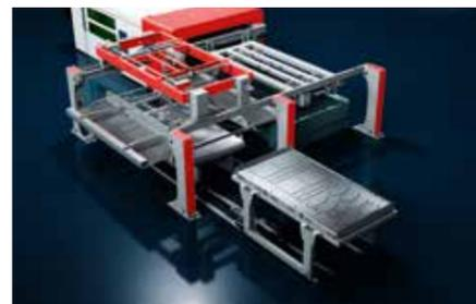
Lo SkyWay è costituito da due manipolatori separati, uno per il carico e uno per lo scarico. In questo modo possono essere eseguite diverse operazioni contemporaneamente, riducendo il tempo di ciclo al minimo assoluto di 58 secondi (3015). Il dispositivo a spazzole rimuove automaticamente i residui lasciati sul pallet del sistema laser per garantire un processo di automazione stabile.
