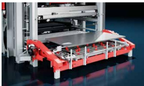
Per il disimballaggio della materia prima, un dispositivo con molti perni è installato sotto all'elevatore. Questo permette di rimuovere barre di legno con un'altezza massima di 100 mm, senza la necessità di una stazione di disimballaggio separata.
