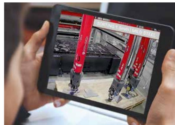
Le 4 telecamere installate in varie posizioni dell'impianto forniscono una panoramica dettagliata e diretta dell'intero processo di automazione in modo che il nostro servizio di help desk possa seguire singolarmente ogni operazione e intervenire in qualsiasi momento tramite telecomando.
