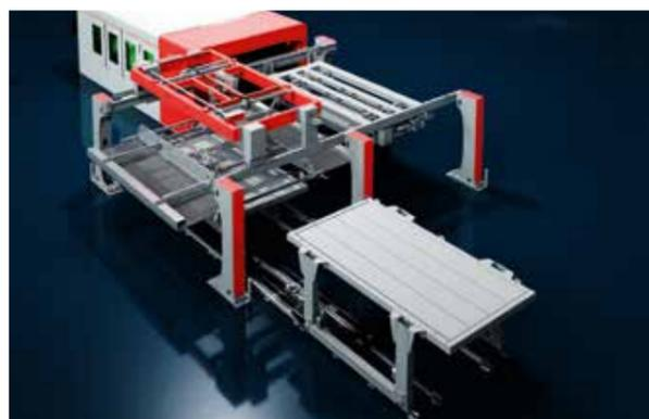
Il velocissimo sistema di carico e scarico SkyWay separa i processi tra taglio laser e prelievo pezzi, consentendo un notevole aumento dell'utilizzo del sistema laser. Lo SkyWay carica il cambio pallet del sistema laser con la materia prima e scarica i fogli tagliati, il tutto in 58 secondi!
