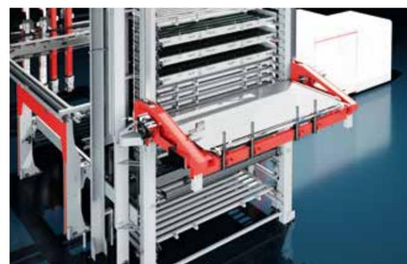
Lo SkyWay può essere collegato a vari tipi di sistemi di immagazzinamento. Che si tratti di un sistema a torre singola, doppia o multi-torre, ci adattiamo alle vostre esigenze. Per ottimizzare lo spazio richiesto, SkyWay può essere integrato direttamente in un sistema di stoccaggio automatico consentendo a entrambe le unità manipolatrici di spostarsi nella torre di stoccaggio.
