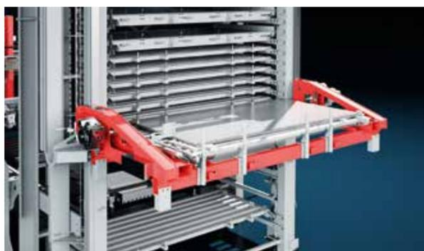
L'elevatore dei sistemi di stoccaggio StoreGo è dotato di un asse aggiuntivo per prelevare i pallet/vassoio di stoccaggio più velocemente rispetto ai sistemi tradizionali.
