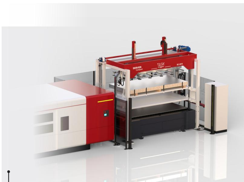
Il sistema Server Compact è costituito da una struttura saldata, adibita ad ospitare sulle due baie di carico e scarico, rispettivamente il carico di lamiere grezze e di lamiere lavorate. Il sistema può funzionare in automatico caricando i grezzi e scaricando i lavorati fino a che la baia di carico ha grezzi da caricare, oppure la baia di scarico ha raggiunto il massimo carico consentito.
